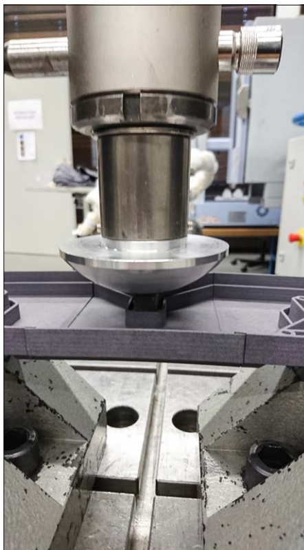
Dreipunktbiegeversuch von einem mit Ultraschallschweissen verbundenen Bauteil.
