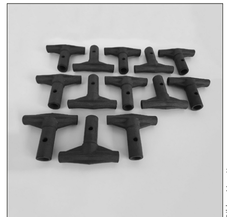
Dank CT-Verfahren konnte die Schwachstelle in diesen Verbindungswinkeln gefunden werden.
