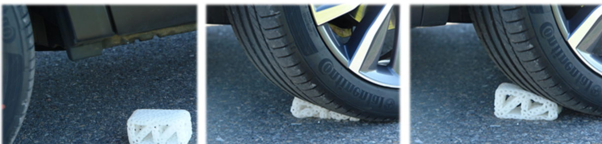
Abb. 2: Das lasergesinterte TPU80 Teil nimmt nach der starken Beanspruchung wieder seine ursprüngliche Gestalt an.
