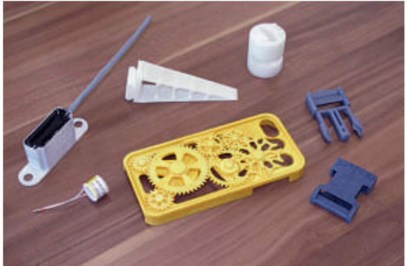
In der Mitte eine zu Demonstrationszwecken lasergesinterte iPhone-Hülle mit Zahnradmechanik, montagefrei produziert.
