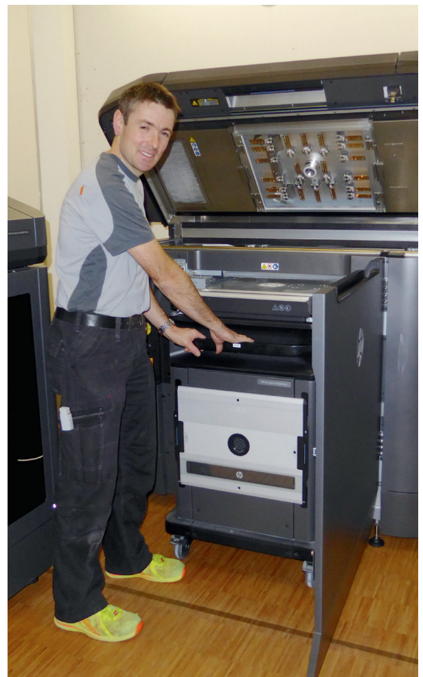
Produktionsleiter Mauritius Mazenauer schiebt den Bauraumwagen in den HP-Drucker vom Typ Jet Fusion 3D 4200 (Bilder: TR)
