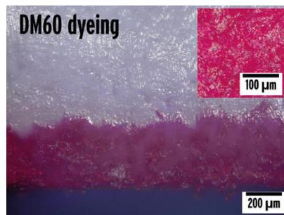
Abb. 2: Die Farb-Eindringtiefe ins PA-HF Material beträgt bis zu 0.3mm (DM)
